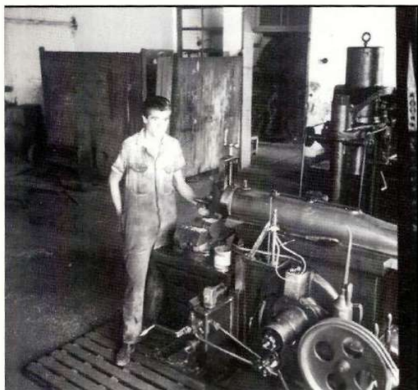
Oficinas do Taboão, plaina limadora, 1967 - Foto de A. M. Cestari.
