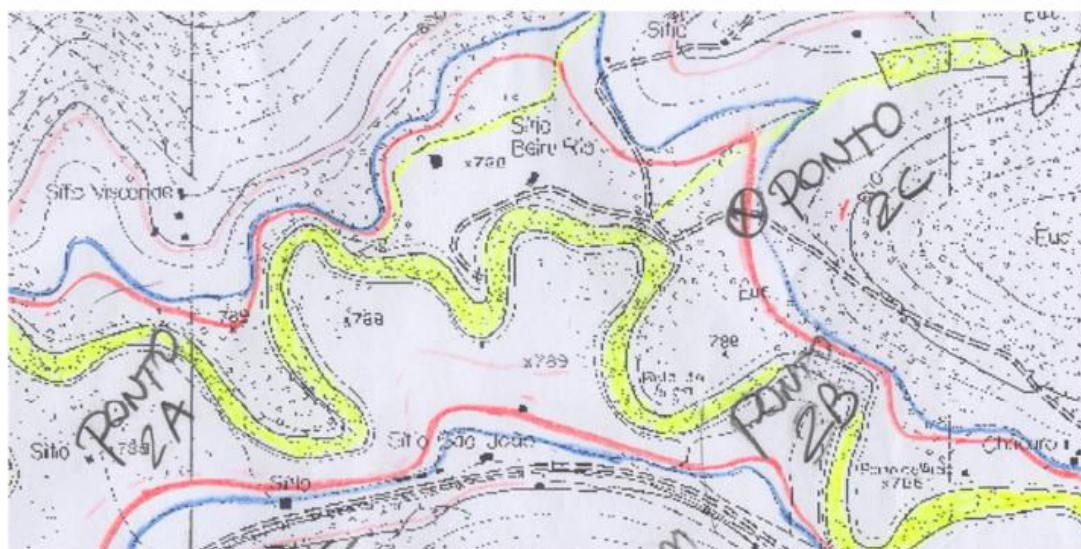
Figura 5.7.16. Ilustração que exemplifica o trabalho de interpolação sobre a base topográfica 1:10.000. A linha em vermelho correspondente a cota de inundação resultante da interpolação.
