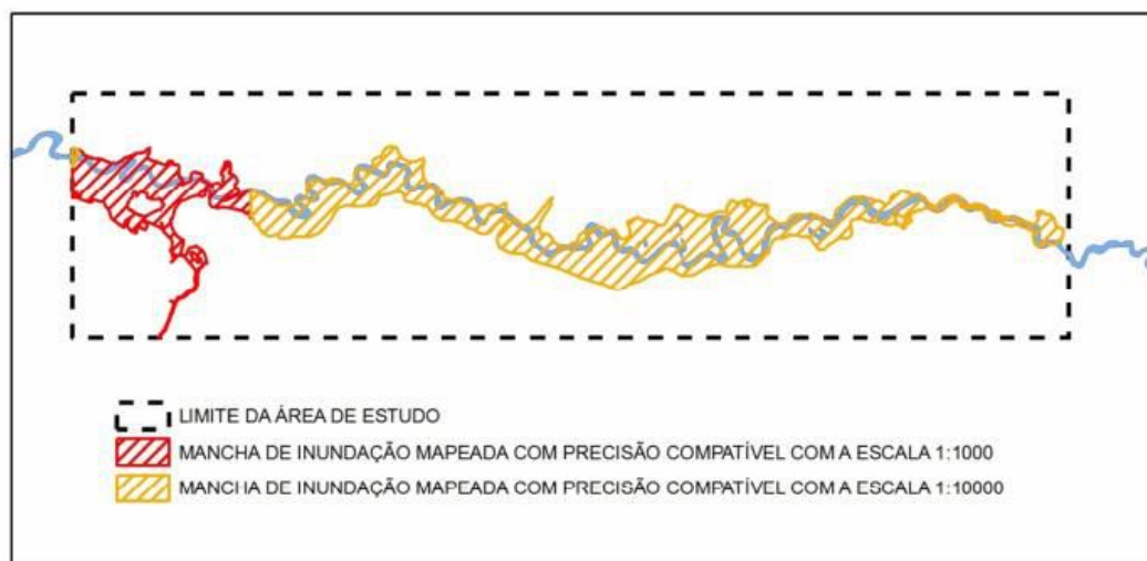
Figura 6.4.21 - Mancha de inundação mapeada em escalas diferentes que implicam na precisão dos resultados
