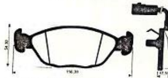
PSA 712 - Sistema Teves Gol, Quantum 2.0, Santana 2.0/1.8 94/ Gol GTI 16v, Parati 16v, Gol 2.0, Parati 1.8 95/
